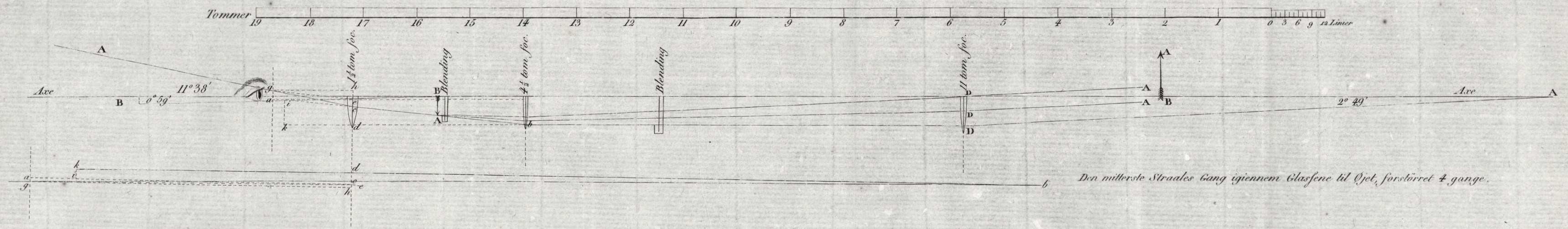
Fig: I. Et Telescope, hvorved Objectet sees med bar Syn ret og i naturlig Stilling, saa og igiennem Glasfene tillige omvendt-og forstørret.
